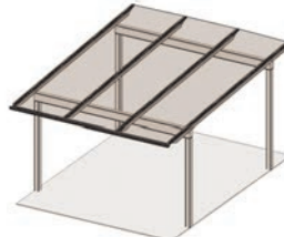
Pulldach freistehend mit Dachüberstand vorn und hinten
