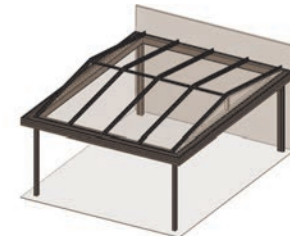
flaches Satteldach, freistehend mit umlaufender Rinne
